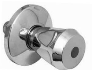
Unterputz-Oberteil DN15 – G1/2" mit ABS-Kunststoff-Griff Hülse und Schubrosette
